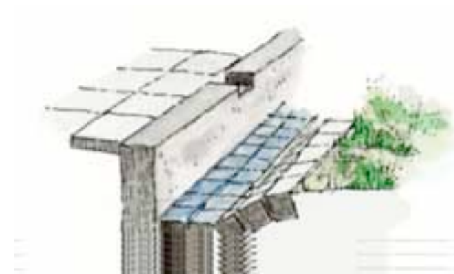
Kuva 17-16 Hulevesikanaali, johon vesi johdetaan reunakivessä olevasta aukosta. Kouru pidetään puhtaana hiekasta ja kasvillisuudesta. (Piiros Pekka Kärppä)
