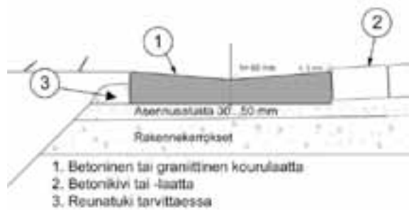
Kuva 14-35 Esimerkki kourulaatan rakenteesta (FCG).
