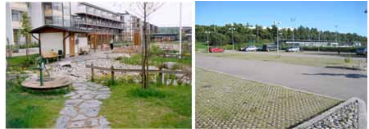
Kuva 16-8 Helsingin Eko-Viikin asuinalueella varastoidaan, viivytetään ja puhdistetaan hulevesiä pihoiden ja pysäköintialueilla. Vasemmalla hulevesiä hyödyntävä kastelukaivo ja kivetty hule-vesipainanne, oikealla vettä läpäisevää nurmikiveystä. (Kuvat Eeva Eitsi)
