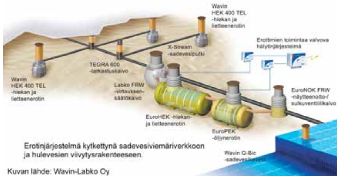
Kuva 14-57 Esimerkki Öljynerotinjärjestelmästä osana muuta hulevesiverkostoa (Wavin-Labko Oy).
