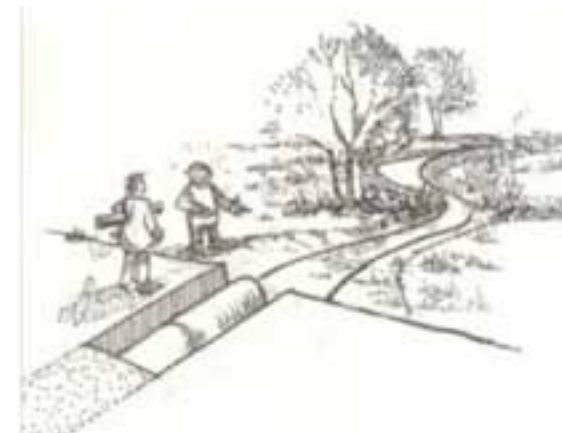
Kuva 17-2 Avoimissa järjestelmissä tarvitaan yleensä osuuksia, joissa on hulevesiputkistoa ja kaivoja. Ratkaisut tulee sovittaa kohteen mukaan. (Piirros Pekka Kärppä)
