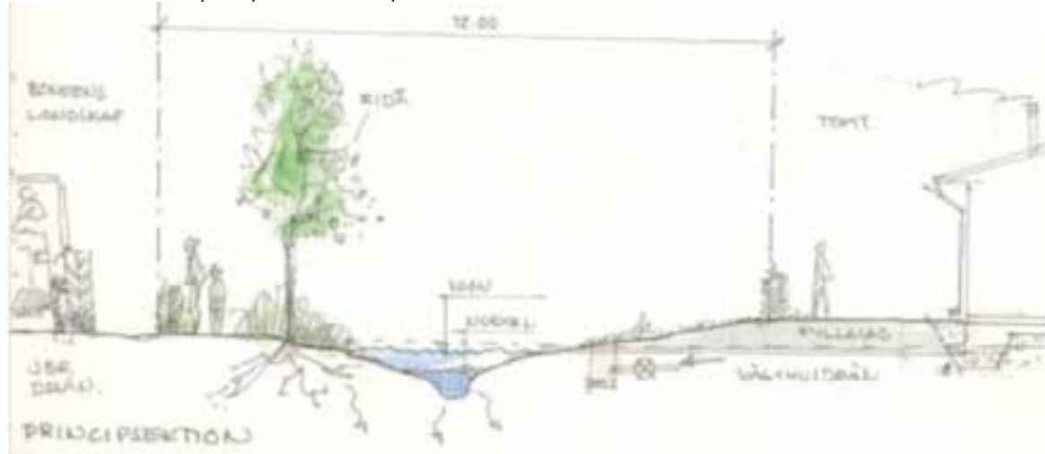
Kuva 17-1 Periaatekuva hoitoalueiden vastuista (ja asuinrakennusten sijoittelusta korkeuden suhteen). Hulevesi ei saa nousta rakennusten perustuksiin. (Piirros Pekka Kärppä)
