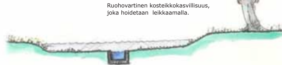
Kuva 17-28 Periaatekuvia erilaisista imeytysrakenteiden profileista. Erilaiset vedenpinnan korkeudet vaikuttavat kosteustasoon, kasvillisuuden valintaan ja hoitoon. Nurmikolla on hyvä imeyttämiskyky ja se kestää kuivana kautena myös ruohonleikkurin renkaan paineen.
