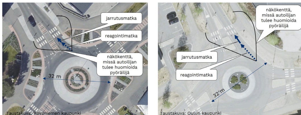
Kuva 11. Esimerkit siitä, missä vaiheessa autoilijan on viimeistään havainnoitava pyöräilijä, jotta hän ehtii pysähtyä ennen pyörätien jatketta eri ajonopeuksilla. Vasemmalla kaupunkikiertoliittymä Rovaniemeltä ja oikealla Väyläviraston ohjeen mukainen kiertoliittymä Oulusta (autoilijan nopeudet 22 ja 32 km/h ja pyöräilijän molemmissa 17 km/h, kuva suuntaa antava).
