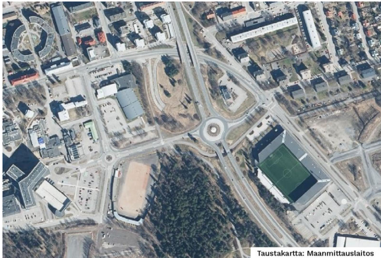
Kuva 5. Vaasan keskustan sisääntulotiellä on kiertoliittymä tiiviisti rakennetun ja väljän alueen rajalla. Samalla se on moottoritien ja kaupunkikeskustan pääkadun muutoskohta. Huomaa, että tämä kiertoliittymä ei ole kaupunkikiertoliittymä.
