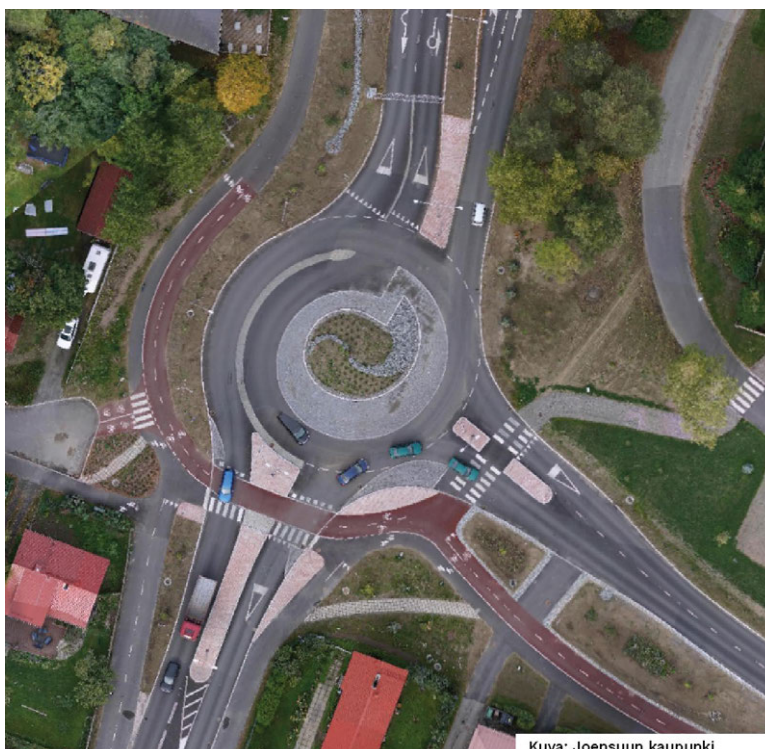
Kuva 6. Joensuussa kiertoliittymä on keskustaan suuntautuvan pääkadun (valtatien jatke sisääntuloväylänä) ja ruutukaavakeskustan rajalla. Liittymä on myös pääkadun 2+2- ja 1+1-kaistaisten poikkileikkausten muutoskohtana.
