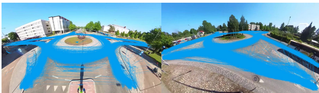
Kuva 12. Vasemmalla Koulukadun ja Siltakadun kaupunkikiertoliittymän ja oikealla Väyläviraston ohjeen mukaan toteutetun Niinivaarantien ja Hukanhaudantien kiertoliittymän ajouria Joensuussa. (360-kameralla otetusta videosta tulkitut ja yhdistetyt ajourat, oikeanpuoleisessa kuvassa ajourat ovat suurempia kuin vasemmalla, © Ramboll).
