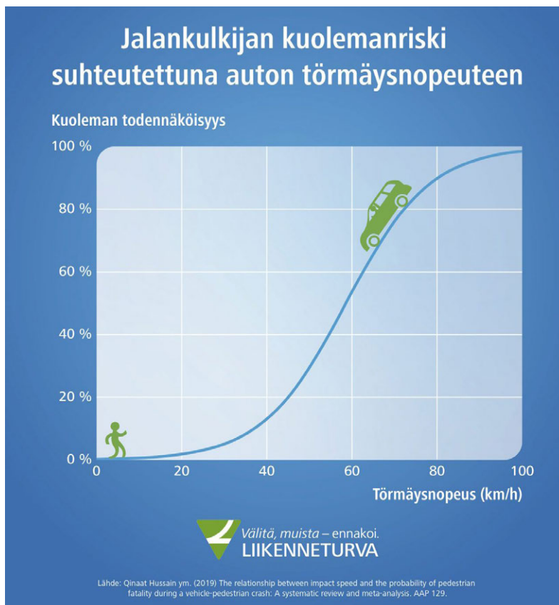
Kuva 10. Jalankulkijan kuolemanriski suhteutettuna auton törmäysnopeuteen 12 .
