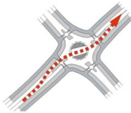
Kuva 29. Erikoiskuljetusten reitin periaatteellinen ratkaisu kiertosaarekkeen läpi 9 .
